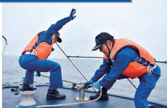
アンカーが効いていることを確認したら水深の3倍程度までロープを繰り出し、エンドをクリートに確実に留める。
