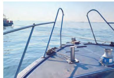
局所的な負荷による船体の破損を避けるため、両舷の船首ビットからラインを取って負荷を分散させる。
