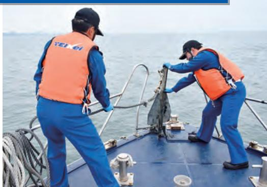
アンカーが着底したら微速で後進し、海底にアンカーのフリューケを引っ掛ける。
