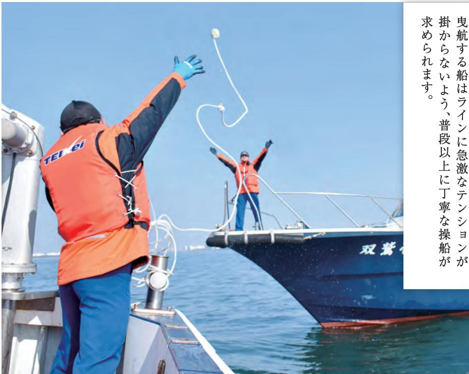
「曳航」とはエンジントラブルなどにより、海上で自走不可となつた船をロープで目的地まで引っ張ることです。曳航する船はラインに急激なテンションが掛からないよう、普段以上に丁寧な操船が求められます。
